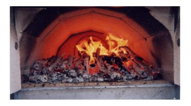
Zuluft und Abluft werden jetzt etwas gedrosselt, in den folgenden 45 bis 60 Minuten verglüht das Holz zu Asche und die Hitze verteilt sich gleichmäßig im ganzen Ofen. Insgesamt ergibt sich damit zum Backen eine Aufheizzeit von ca. 2 Stunden, für sehr hohe und lang anhaltende Temperaturen 1/4 bis 1/2 Stunde mehr.
